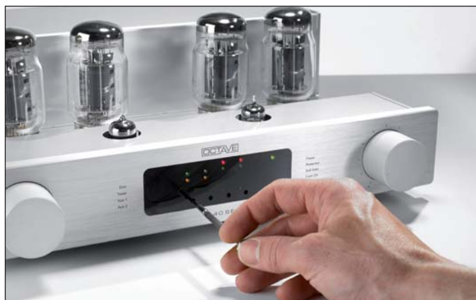
Ruhestrom-Einstellung: Für die kräftigeren 6550 empfiehlt Octave die grün-rote LED-Einstellung, für kleinere EL 34 eine grün-gelbe.
